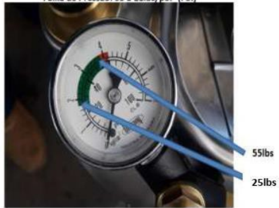
MANÔMETRO Faixa de Pressão: 55 a 211bs/pol 2 (PSI)
