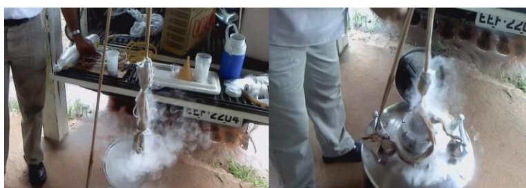
Figura 5. Tubos criogênicos no interior da meia de nylon inserida no botijão de nitrogênio líquido.
