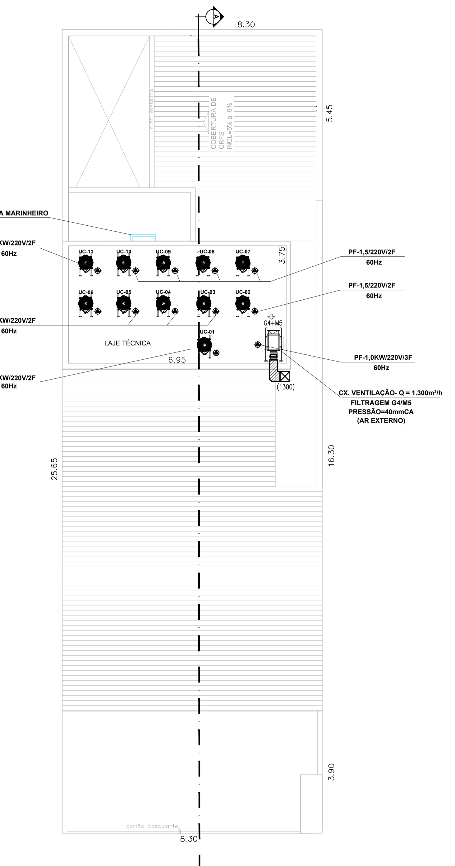
PLANTA REFORMA LAJE TÉCNICA - AR CONDICIONADO ESCALA - 1:75
