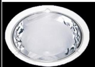
Luminária Circular de embutir, fabricada em alumínio repuxado, pintura de acabamento com tinta em pó, a base de epoxi por sistema eletrostático na cor branca, corpo refletor em alumínio anodizado de alto brilho ou metalizado, aro anti-ofuscante, montada com os seguintes equipamentos: 2 (duas) lâmpadas fluorescentes compactas de 26W, difusor em vidro fosco temperado, soquetes anti-vibratórios, fiação com
