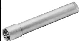
Eletroduto rígido de aço-carbono com costura, tipo pesado, classe LI, com revestimento protetor anti-oxidante, galvanizado à fogo, rosca conforme NBR 8133, fornecido em barras de 3 m de comprimento com uma luva. Fabricado e ensaiado conforme NBR 5624, NBR 6154, NBR 6338, NBR 7398, NBR 7400, NBR 8133.
