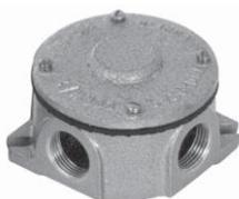
Caixa de passagem ou de ligação de equipamento, para instalação aparente, com entradas roscadas, construída em liga de alumínio de alta resistência mecânica e à corrosão, isentos de qualquer rebarba, tampa aparafusável no mesmo material da caixa, e guarnição de borracha para vedação. Acabamento alumínio natural polido ou em pintura epóxi na cor cinza. Para instalações externas, as entradas devem ter roscas do tipo BSP.
