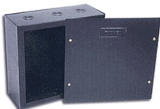
Caixa de derivação construída em chapa de aço com espessura mínima de 1,2 mm (nº 16), com tratamento anticorrosivo e acabamento em tinta cinza de primeira linha, provida de tampa, aparafusável, no mesmo material, e acessórios de fixação, trazendo impresso na chapa o nome do fabricante. Fabricada e testada conforme NBR 6235 e NBR 6720.
