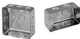
Caixa de derivação construída em chapa de aço com espessura mínima de 1,2 mm (nº 16), estampada e esmaltada a quente, com entradas para eletrodutos de 1/2" e 3/4", trazendo impresso na chapa o nome do fabricante. Fabricada e testada conforme NBR 6235 e NBR 6720.
