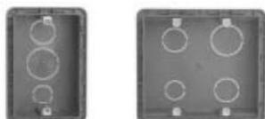
Caixa de passagem ou derivação de 4x2" ou 4x4", em termoplástico de alto impacto, de alta resistência mecânica, orelhas de fixação em aço com tratamento anti-ferrugem, para montagem embutida, 2 (duas) entradas para eletroduto
