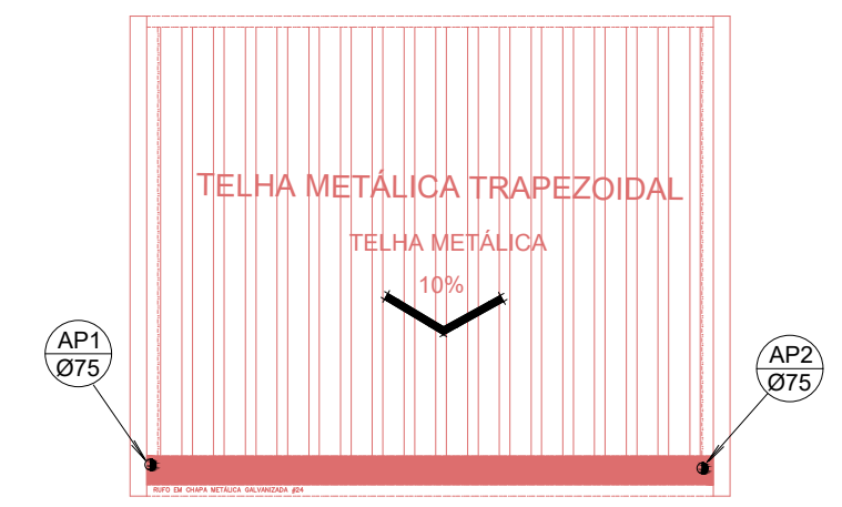
PLANTA COBERTURA ESCALA 1:75
