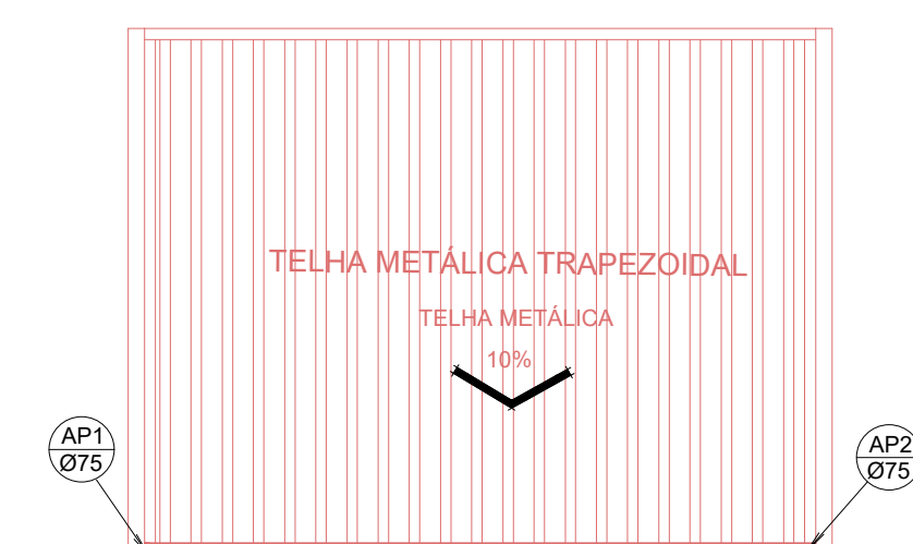
PLANTA COBERTURA ESCALA 1:75
