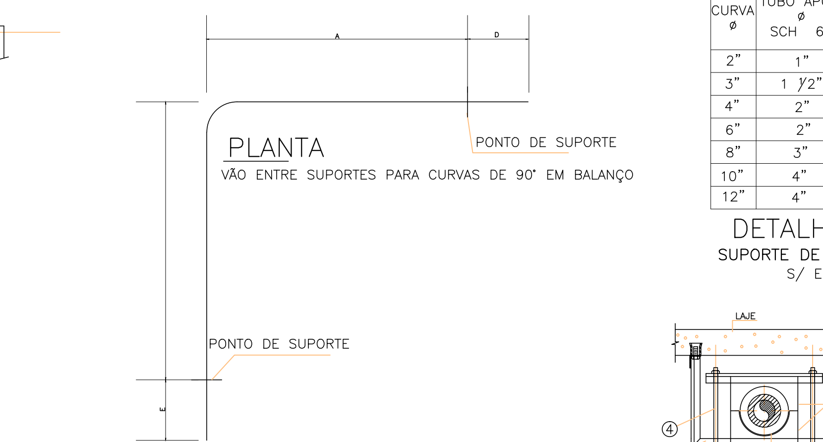
DETALHE 08 SUPORTE DE ANCORAGEM S/ ESC.
