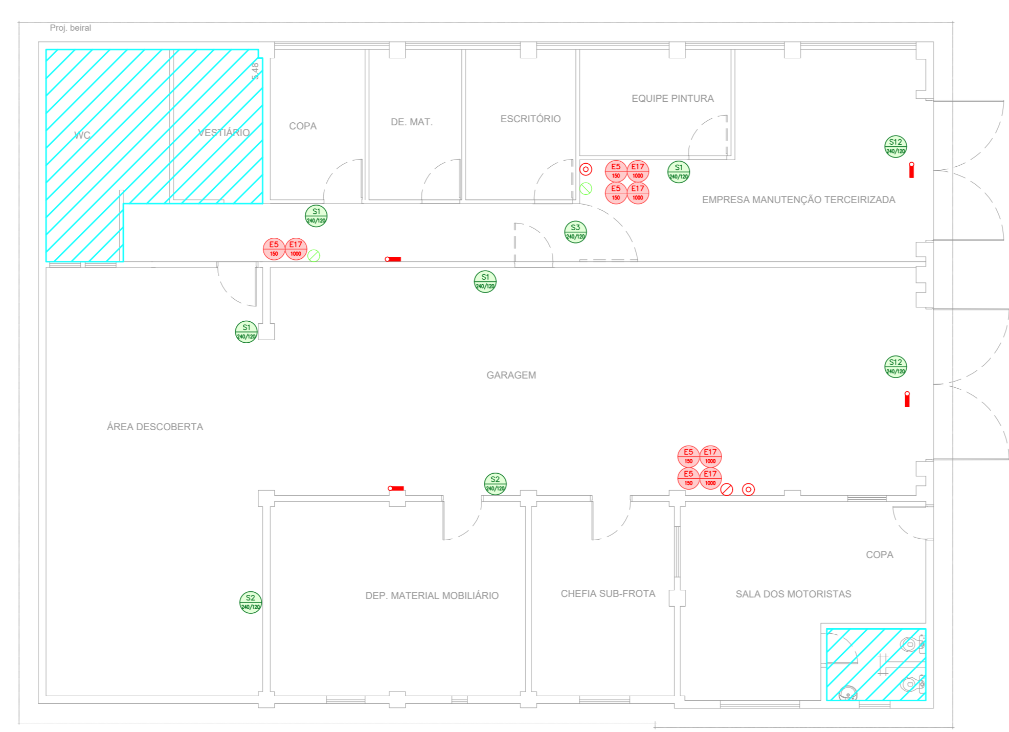
9 CAISM PHILIPPE PINEL - EDIFÍCIO 52 PROJETO BÁSICO DOS SISTEMAS DE INCÊNDIO PLANTA BAIXA - SUB-FROTA ESCALA 1:100 METRO
